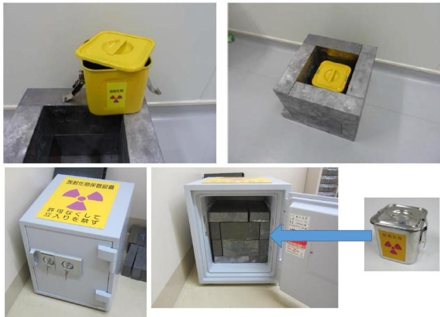
Fig.9 放射化物を入れる容器の例(上段)とその保管例(下段)
