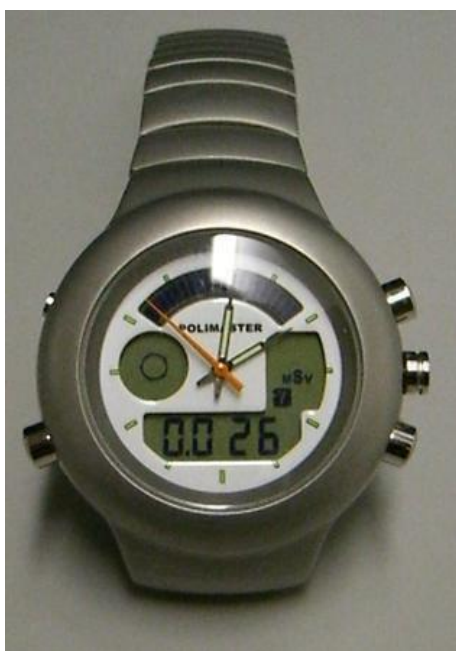
図2 腕時計型線量計(POLIMASTER 社, PM1208)
