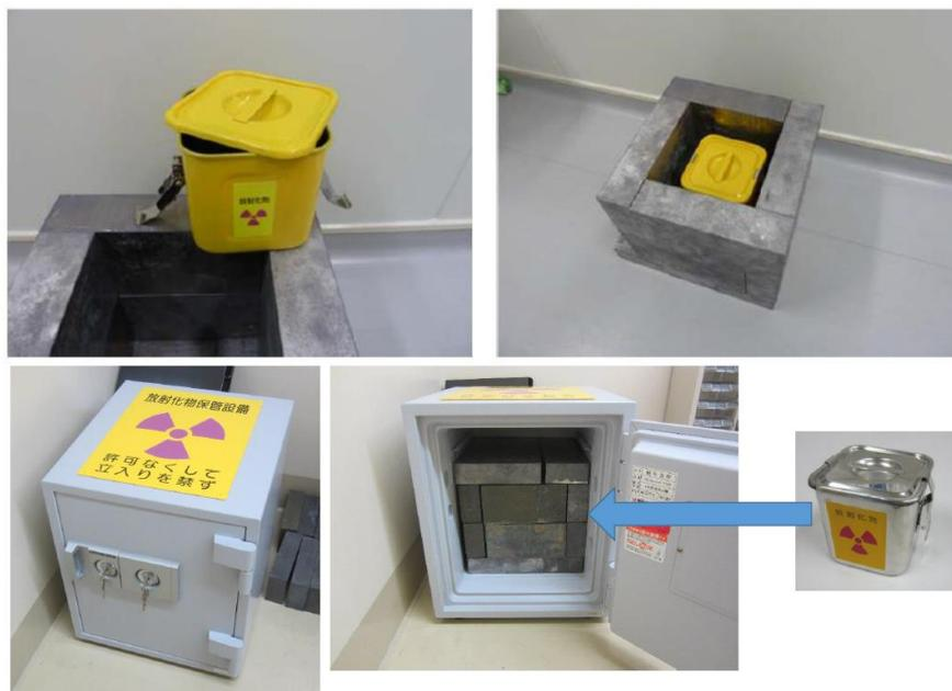
Fig.9 放射化物を入れる容器の例(上段)とその保管例(下段)
