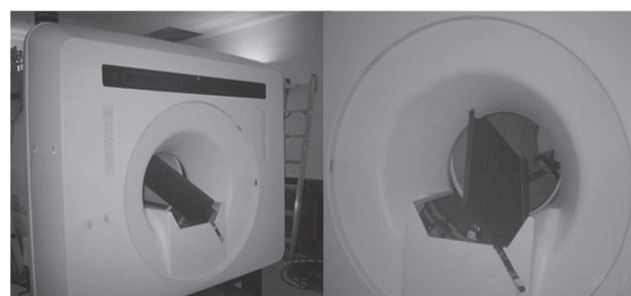
Fig. 8 工事関係者が持ち込んだ鉄板の吸引例
