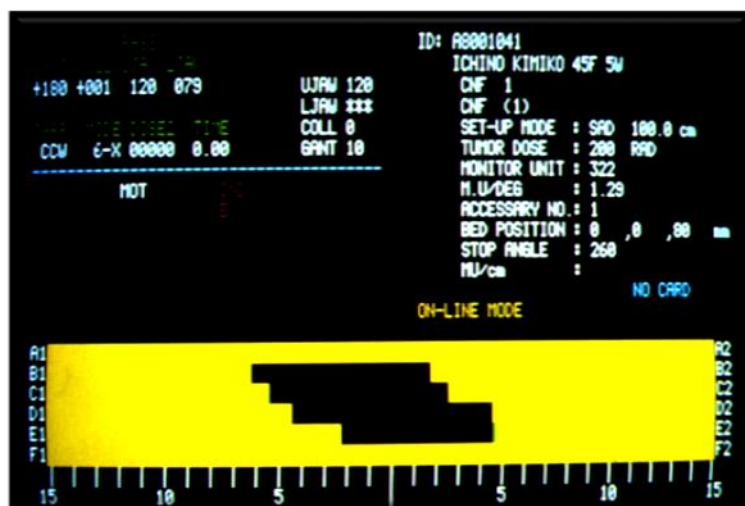
PC を内蔵した NEC リニアックの CRT, 原体照射など照射野、治療パラメータの表示 (1985 年): 現リニアックの原型
