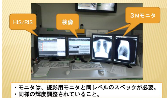
Fig.3 基本的な検像システムの構成
