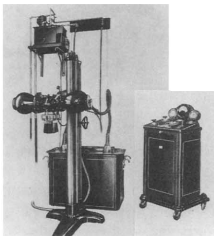
図2.103 1940年頃の国産治療装置(東芝) 上) KXC-450A (450kV、3mA連続) 倍電圧方式(クライナッヘル回路) 下) KXC-17 (230kV、6mA) 倍電圧整流(クライナッヘル回路)
