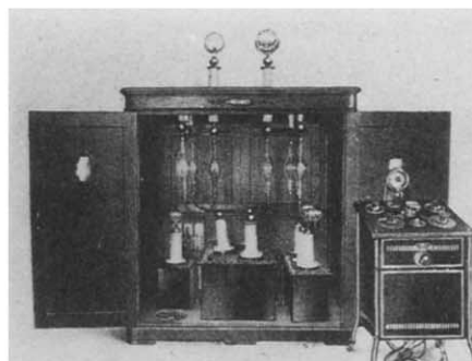
図2.117 初期の頃の国産三相装置 愛石 最高電圧115kV、最大電流1,000mA 1930年頃 (島津製作所)
