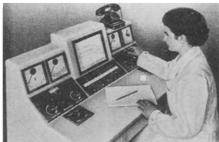
図 2. 134 1938年 Siemens 社が発表した Codiaphos (100kV、 3\mu\text{F} ) の制御器。
