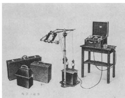
図2. 88 1925年頃の可搬形装置 (Victor社) 85kV、10mA
