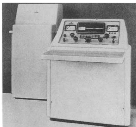
図2.121 1956年に作られた三相12ピーク装置“Tridoros 4” (Siemens社)
