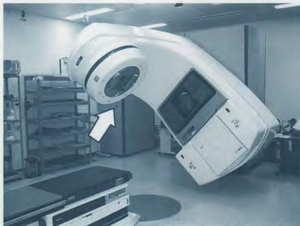
図1 放射線治療装置：矢印の先から放射線が出ます。装置は回転し、いろんな方向から放射線を当てることができます。
