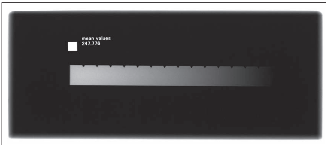
Fig. 22 Bits allocatedの影響 8 bitデータを 8 bitとして読み込んだ場合、バックグラウンドROI内の平均デジタル値は247.776であった。
