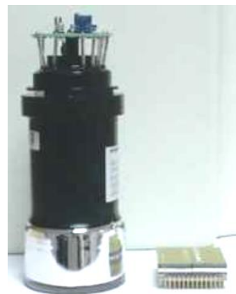
図 2. 従来タイプ検出器と半導体検出器
