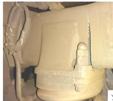
台車枠の側面に入った亀裂＝ＪＲ西日本提供
