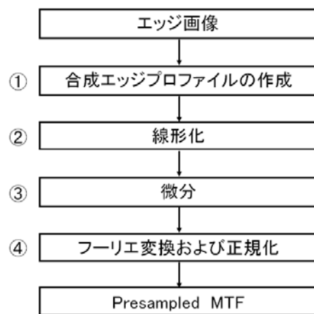
Fig. 4 エッジ法における presampled MTF 解析の手順
