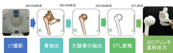
図 2 THA 術前シミュレーションモデルの作成工程
