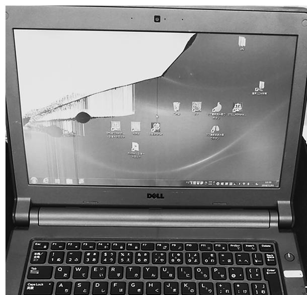
Fig. 2 携帯形表示デバイスの損傷例
