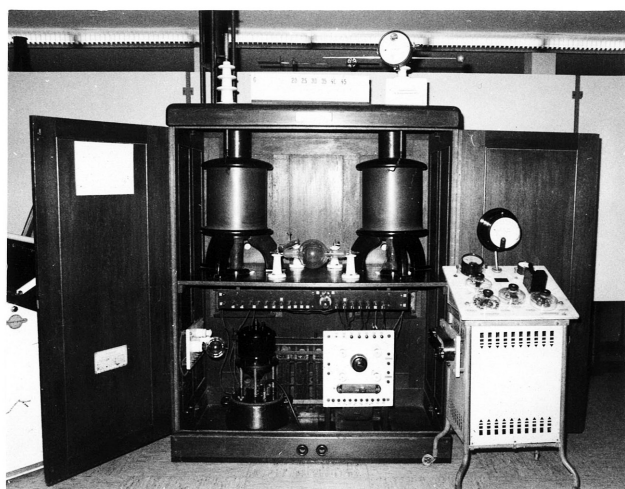
Fig. 26 深部撮影装置（1922年，ライニゲル社シンメトリ） ドイツ，レントゲン博物館にて1981年青柳氏撮影
